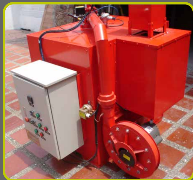
Incineración de Agujas
